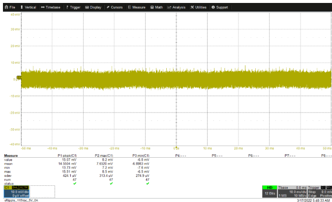
Vin=115 Vac, 60Hz, VoutA=5 V, Iout=0 A ( \Delta V_{out} =15.5 mV)
