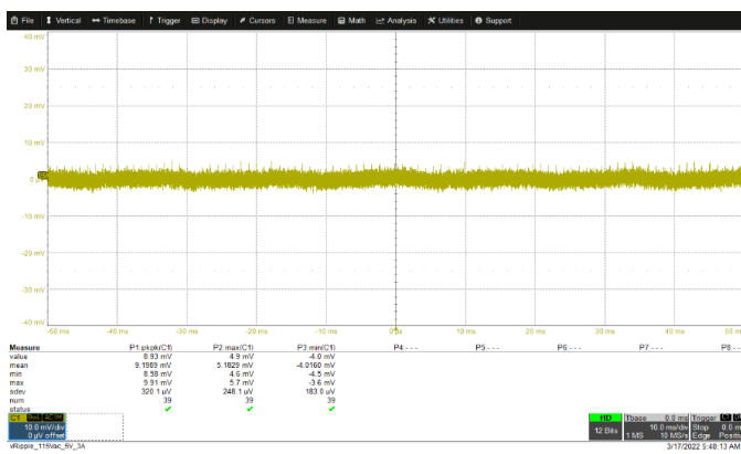
Vin=115 Vac, 60Hz, VoutA=5 V, Iout=3 A ( \Delta V_{out} =9.9 mV)
